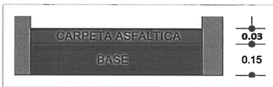
Fig. N° 4. Estructura de Pavimento flexible para ciclovia
